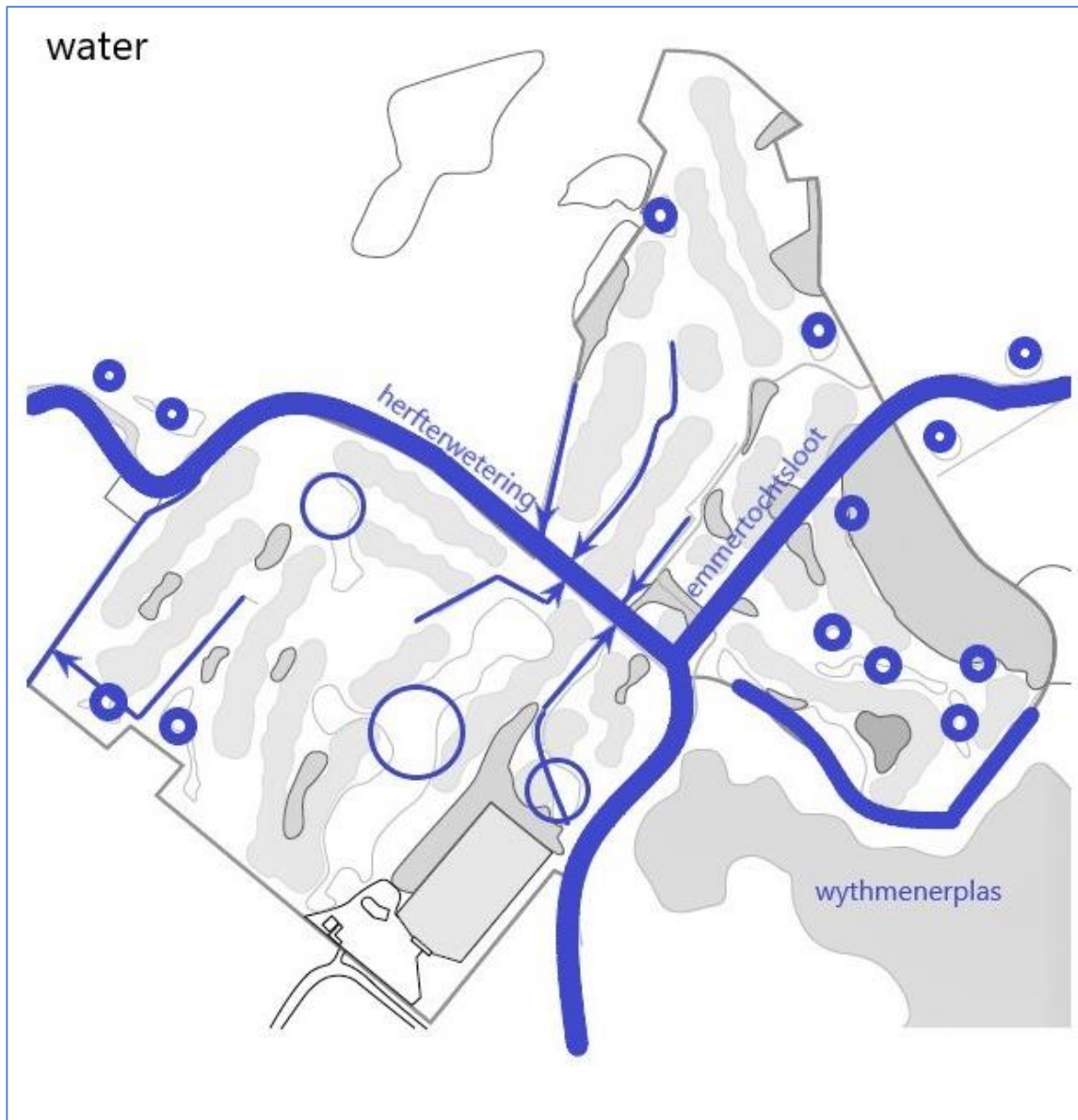
Figuur 6 water op en rond de golfbaan (kleine cirkels zijn poelen, grote cirkels zijn grotere wateren, de pijlen geven de afwateringsrichting weer van de golfbaan via sloten naar de Herfterwetering)
